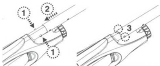
Чтобы освободить телескопическую штангу, одновременно нажмите на два боковых штифта, а затем вытяните штангу.
