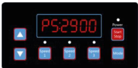
Рисунок 4.22, Скорость самозаполнения, по умолчанию 2900 об/мин
