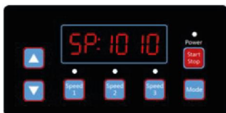
Рисунок 4.10, 1000 об/мин нажмите "Вверх" один раз
