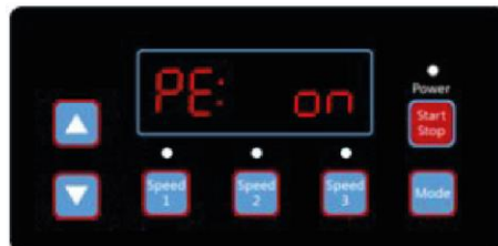
Рисунок 4.23, Самозаполнение Вкл/Выкл, по умолчанию Вкл.
