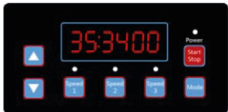
Рисунок 4.20, График работы 3 Скорость, по умолчанию 3400 об/мин
