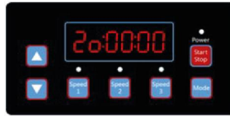
Рисунок 4.17, График работы 2 Время вкл., по умолчанию 00:00
