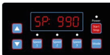
Рисунок 4.11, 1000 об/мин нажмите "Вниз" один раз
