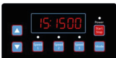
Рисунок 4.12, График работы 1 Скорость, по умолчанию 1500 об/мин
