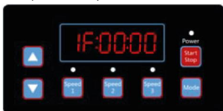
Рисунок 4.14, График работы 1 Время выкл., по умолчанию 00:00
