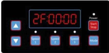
Рисунок 4.18, График работы 2 Время выкл., по умолчанию 00:00
