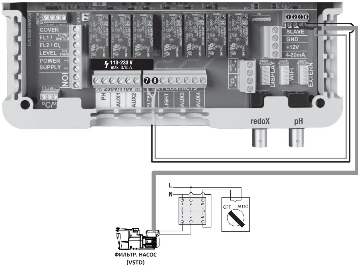
При использовании насоса с переменной скоростью Hayward, оснащенного цифровыми входами, соедините общий черный провод, подсоединенный к терминалу (C), с терминалом (7) и следуйте инструкциям по подключению, приведенным в следующей таблице. Вы должны будете снять 15 см цифрового кабеля и обрезать оранжевый провод.
