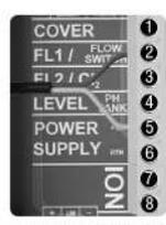
Можно добавить внешний переключатель потока к системе. Соедините как показано на рисунке и свяжитесь с вашим инсталлятором для активации. Титановая ячейка включает датчик газового расхода, вы можете комбинировать оба для лучшего контроля.
