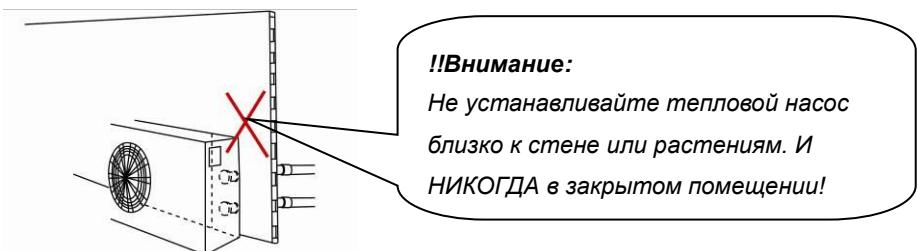
2. Нагреватель должен быть расположен в прочной, ровной и не подверженной коррозии конструкции, способной выдержать вес теплового насоса. Он должен крепиться болтами (M10) к бетонному фундаменту.
